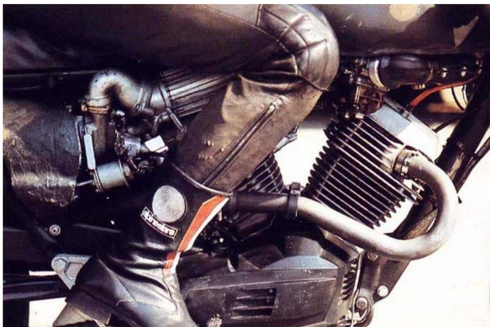
nella parte interna dello scambiatore, poco prima di entrare nel compressore veniva effettuata l'iniezione di benzina, e all'uscita dal compressore veniva fatta passare nella camera intermedia dell'intercooler, potendo così venir raffreddata, prima di entrare nei cilindri. Lo schema era quello che pubblicizzava la Moto Morini a quei tempi, ma giurerei che non fosse proprio così al 100%. Ovviamente la miscela aria/benzina poteva venir raffreddata non solo a spese
