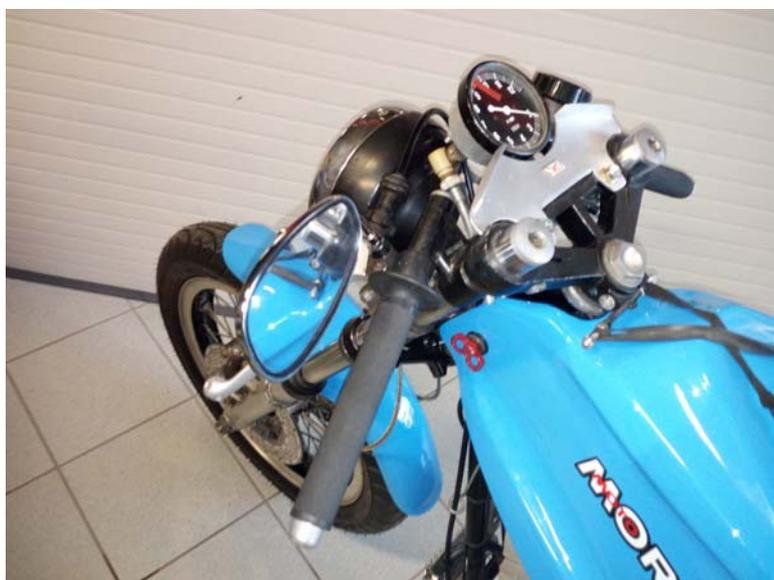
classico con cerchi in alluminio a raggi, impianto frenante con doppi dischi forati e svasati, la piastra sterzo è l'originale ma modificata con un unico strumento, un contagiri Veglia Borletti. Ci fa rimarcare che quasi tutti i componenti sono originali dell'epoca, come appunto il contagiri, le pedane arretrate della Cinque Anelli in magnesio, i semimanubri Menani, dietro un bel paio di ammortizzatori della FAC etc .....
