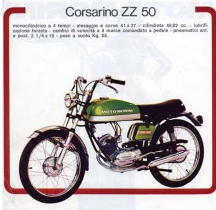
monocilindrico a 4 tempi - alesaggio e corsa 41x37 - cilindrata 48,82 cc. - lubrificazione forzata - cambio di velocità a 4 marce comandato a pedale - pneumatici ant. e post. 2 1/8 x 18 - peso a vuoto Kg. 54.
