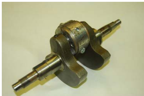
Fig. 4 Albero motore 350 con bussola per equilibratura dinamica
