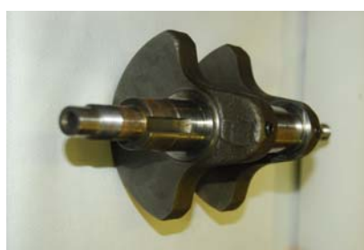
Fig. 3 Albero motore Kanguro con contrappesi a mannaia (post 83)
