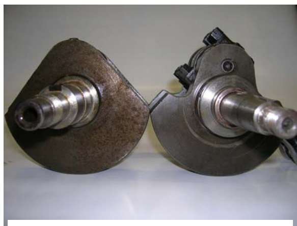
Fig. 2 Confronto tra un albero motore 350 pre-83 (sn) e un altro dello stesso tipo ma con contrappesi modificati a mannaia
