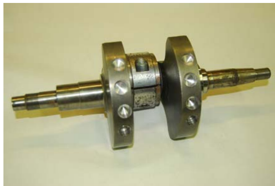
Fig. 5a Fori di equilibratura sulle mannaie dell'albero motore 350 cc
