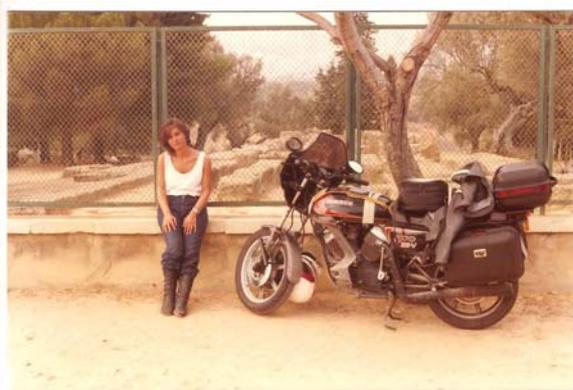
vuoi soprattutto per una ciclistica molto più evoluta. Ora ho 3 freni a disco che frenano, cerchi in lega, ammortizzatore di sterzo e un motorino d'avviamento . Il motore poi, dopo un periodo di rodaggio con attenzioni maniacali, si rivelerà sicuramente più adatto all'uso in coppia, con una risposta pronta fino dai 2.000 giri ed una infaticabile resistenza nei lunghi viaggi a pieno carico.
